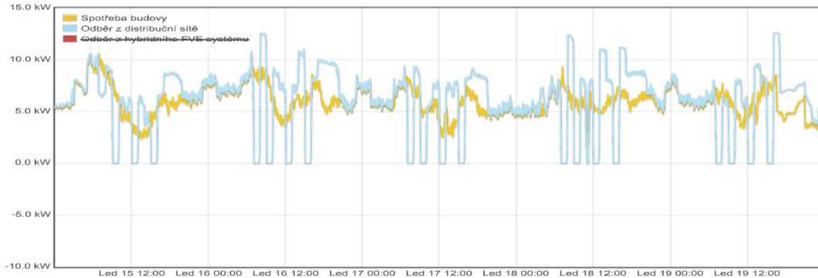
Spotřeba budovy, výroba, dodávka (kW)
